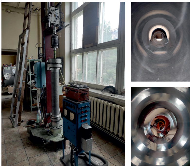
Рис. 1. Финишная механическая полировка трубы (слева), исходное состояние трубы при покупке (справа сверху) и итоговое состояние трубы (справа снизу)
