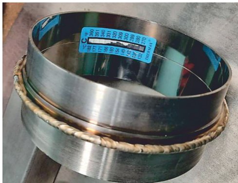
Рис. 8. Отработка технологии сварки напыленных поверхностей нейтроновода УХН на образцах-свидетелях
